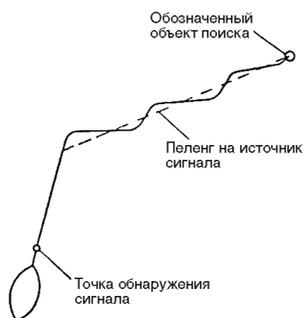
**Рис. 3.2. Схема маневрирования поискового судна при сближении с объектом по данным радиопеленгатора**
