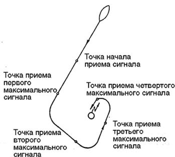
**Рис. 3.3. Схема маневрирования поискового судна при использовании в качестве средства поиска приемных устройств**
